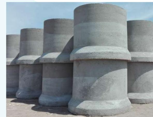
Son utilizados para la construcción de alcantarillas, conducción de agua, puentes sobre canales o acequias y desagües pluviales. En uno de sus extremos poseen un encastre machimbrado que permite realizar una junta estanca y facilitar la linealidad del conducto.
