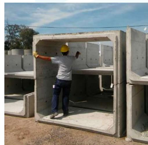
Las alcantarillas modulares prefabricadas denominadas "Conductos" son un sistema aprobado por distintas reparticiones para ser utilizados tanto en rutas provinciales como nacionales. Se pueden destacar un sin número de ventajas con respecto al sistema tradicional in-situ.
